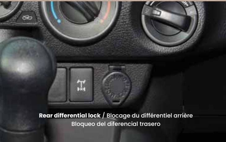
Rear differential lock / Blocage du différentiel arrière
